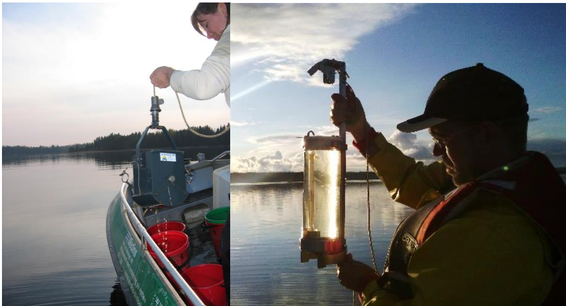
Exempel på provtagningar som utförs i Arbogaåns recipientkontroll. Längst till vänster provtagning av bottenfauna med ekmanhuggare. Till höger vattenkemisk provtagning för analys av bl.a. näringsämnen.
